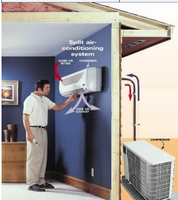
Раздельное оборудование кондиционирования воздуха: настенный внутренний блок и наружный блок
